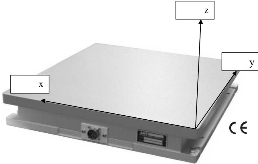
شكل (٢) جهاز منصة القوة (Force platform)
